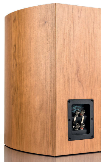
Sporych rozmiarów obudowa ma wyraźnie wypukłe boczne ścianki, dzięki czemu zwiększono objętość skrzynek i zredukowano tendencję do powstawania fal stojących wewnątrz.
