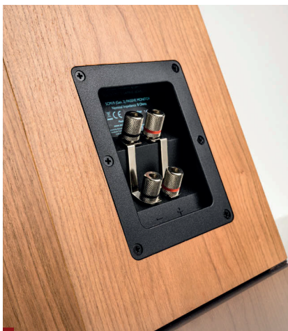
Zwykłe terminale głośnikowe z katalogu dużego dostawcy. Lepiej użyć bananów niż widełek.
