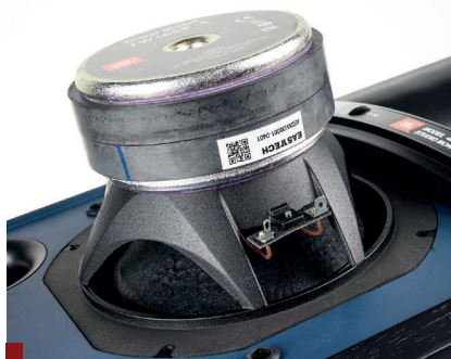
Głośnik nisko-średniotonowy ma bardzo solidny kosz. Wentylację cewki zapewnia wyłącznie otwór w magnesie.
