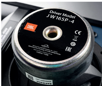
Głośnik nisko-średniotonowy ma bardzo solidny kosz. Wentylację cewki zapewnia wyłącznie otwór w magnesie.
